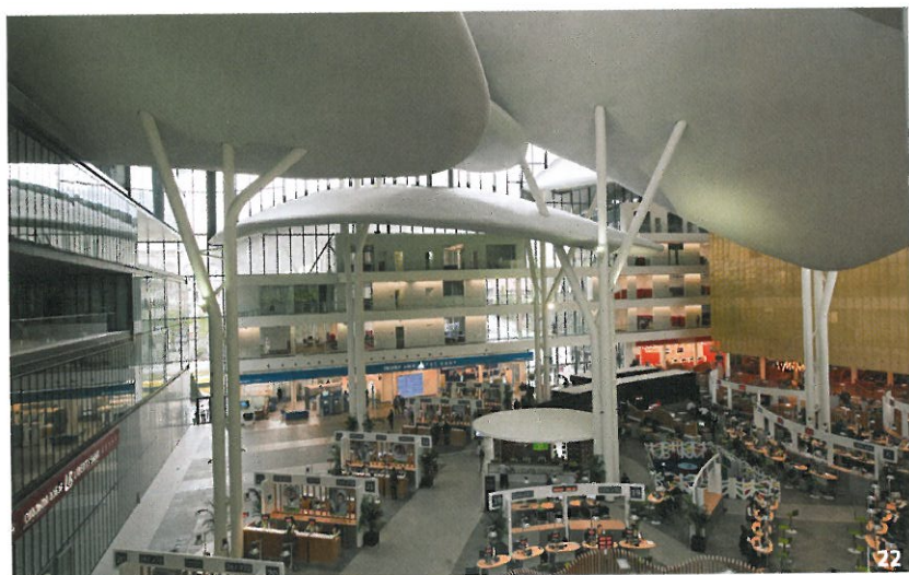
22 | Wokół wspólnego dziedzińca zgrupowanych jest 9 oddzielnych budynków, które połączono kładkami i otoczono ścianą kurtynową
